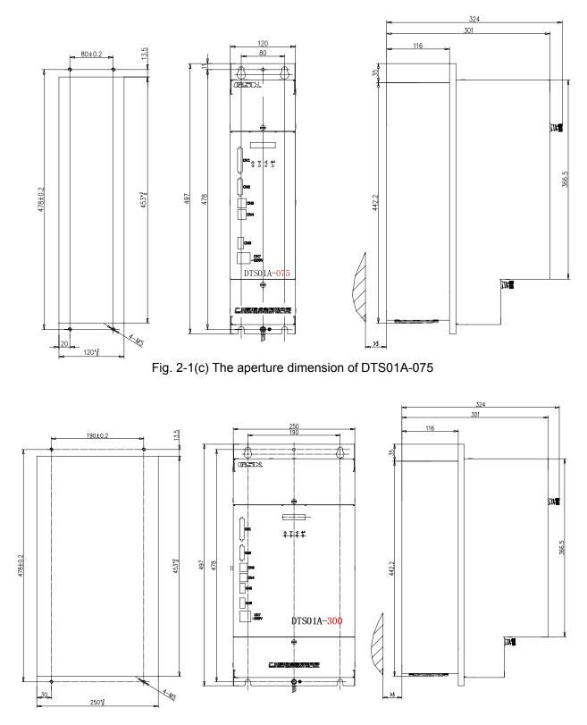
Fig. 2-1(d) The aperture dimension of DTS01A-300
