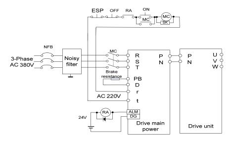
Fig. 7-1 Power module wiring
